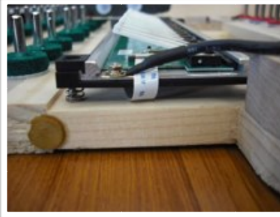
センサーレールの下を通す場合、上下スプリングにケーブルが噛まないように気をつけてください。
