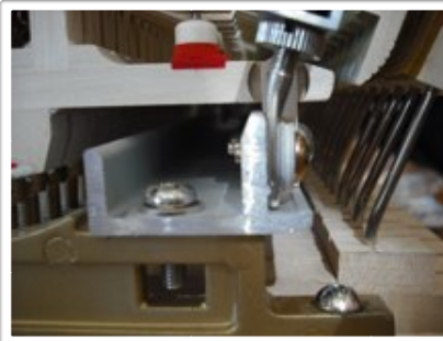
バランスパンチングをワッシャー代わりに使い、ウィッペンレールの内側に余り出ないようにしました。
