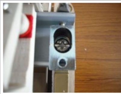
回転レバー軸を立てるベースを付けます。ブラケットに固定しているネジを一旦はずし、そのネジで再度固定しま
