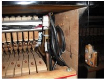
結線後は隙間に押し込みました。 鍵盤ボタンにも干渉しません。
