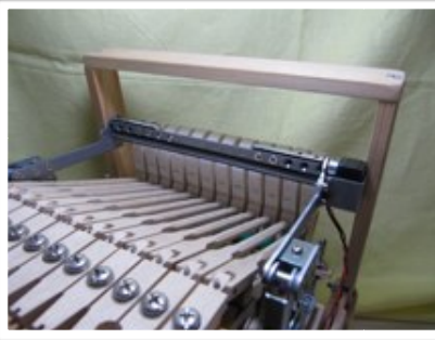
ミュートON状態 モーターは最低音と最高音部の 2カ所に取付けられます。
