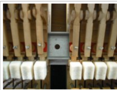
次にM6の穴を貫通しました。
