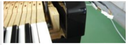
アクションの出し入れ時にケーブルを 外側へ軽く引っ張るようにするとケー ブルの干渉なしに出し入れできます。
