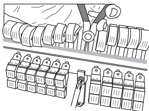
次高音部（ナットをラジオペンチでつまめます。）
