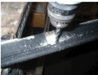
先に切り取る範囲の縦に鉄ノコで切り込みを入れた後に根元はドリルで加工
