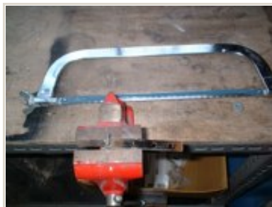
付属のL字金具を短くします。
