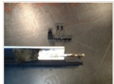
ウデ木内側に干渉しないように内側へハンドルを移動。
