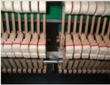
次高音部は先程の短く切ったL字金具をたてます。
