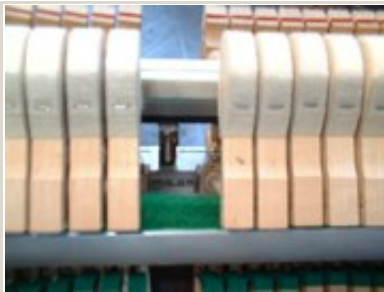
次高音部のレール取付け。
