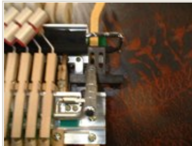
最低音部の穴の位置決めです。 ポンチが役に立ちます。
